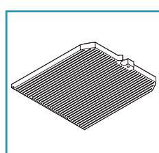
Aktiivihiilisuodattimien tehtävään on pidättää niiden läpi virtaavan ilman hajuja: puhdistettu ilma palautetaan keittiöön suodattimien läpi menon jälkeen.
