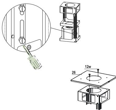
Prima di serrare definitivamente le viti è possibile effettuare delle regolazioni spostando il traliccio, facendo attenzione che le viti non escano dalla sede dell'asola di regolazione.
