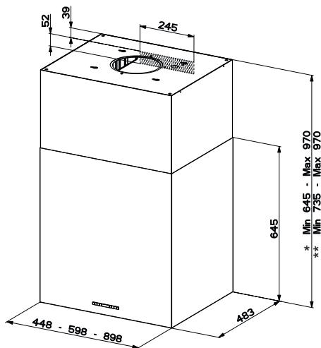
\* Abmessungen der Haube in Abluftversion.
